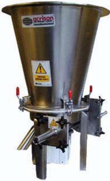
Después de un episodio insatisfactorio utilizando un dosificador de paredes flexibles y un sistema vibratorio, la necesidad de precisión y fácil limpieza guió a Lani BVBA a Acrison. Acrison recomendó el uso del Modelo 170-00 en acero inoxidable, un dosificador volumétrico de huella pequeña, adecuado para dosificaciones bajas, e ideal para rápidos cambios de material.
