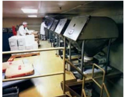
**Trabajadores vacían ingredientes de manteca de maní dentro de estaciones de bolsas posicionadas sobre la parte donde se rellena el Dosificador Volumétrico, para dosificación y mezcla automatizada.**
