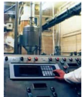
**Un control supervisa la operación del sistema completo de dosificación y cocción, proveyendo cambios en fórmulas y rangos de producción variable.**
