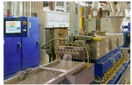
**Las hebras calentadas de resina termoplástica son descargadas del extrusor hacia un baño de agua, en donde son enfriadas antes de ser peletizadas.**
