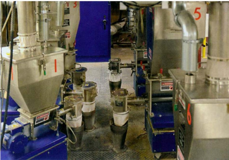
gravimétricos pérdida-de-peso, un dosificador de líquidos pérdida-de-peso, siete controladores, un peletizador, y equipo auxiliar todo integrado al Controlador Aries II HMI de NFM centralmente localizado.
