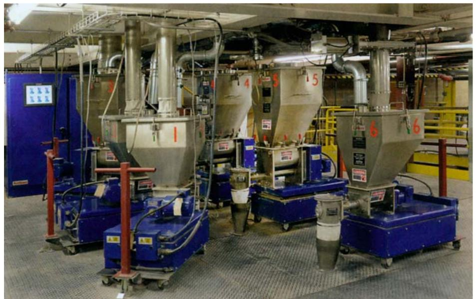
Los seis dosificadores gravimétricos pérdida-de-peso panel de control (atrás a la izquierda) están instalados en una mezanina directamente arriba del extrusor de doble tornillo.
