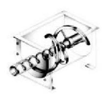
Dado el costo de la materia prima y la variedad de caudales de flujo, era vital tener dosificadores flexibles y fiables dosificando polvo seco al granulador. Acrison suministró versiones gravimétricas y volumétricas de su dosificador 105 con tornillo doble concéntrico de velocidad disimilar, y un modelo volumétrico BDF-11 con tornillo triple de velocidad disimilar, para ser usado en la dosificación de pigmentos.
