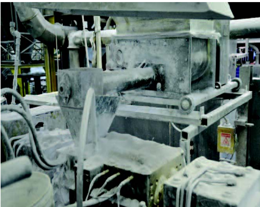
Este sólido dosificador volumétrico ha prevalecido contra la prueba del tiempo, fácilmente soportando el ambiente industrial inhóspito y a la vez requiriendo mínimo mantenimiento.
