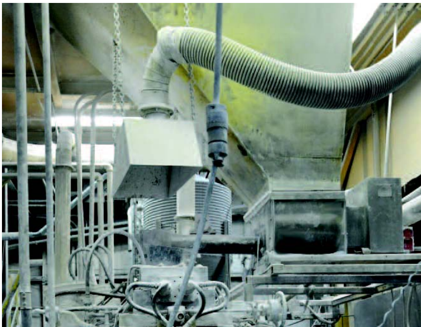
Este dosificador volumétrico dosifica fiablemente un color concentrado al extrusor, asegurando consistencia en el lote y una operación continua.
