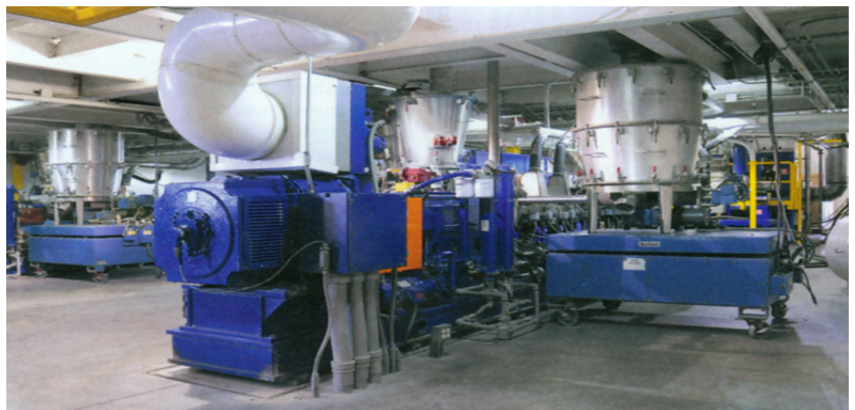
El dosificador principal (en primer plano a la derecha) tiene una tolva de acero inoxidable con una capacidad de 0.57m 3 , y dosifica pellets, polvos, y una mezcla de estos hasta 1,818 kg/hr.
