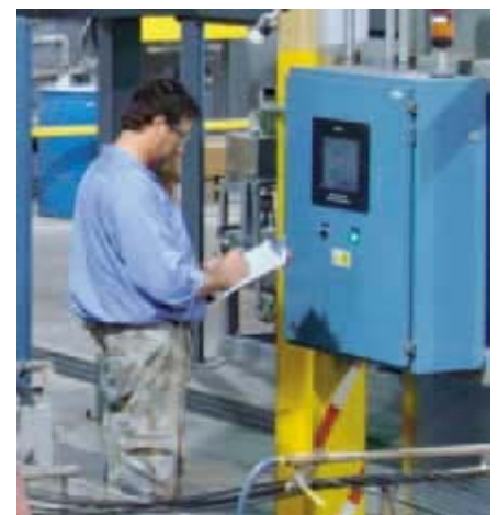
Un operario chequea el desempeño de los dosificadores en el controlador múltiple de una línea extrusora.
