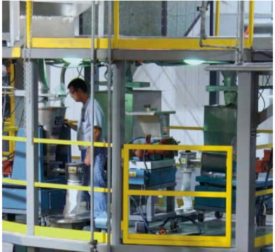
Un operario se encuentra entre los Dosificadores de diferentes tamaños de una línea extrusora en el primer piso.
