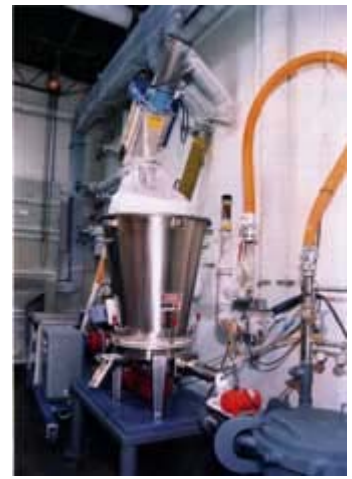
La cámara de alimentación de fondo plano y el agitador acondicionador, dosifican materiales difíciles de manejar uniformemente.
