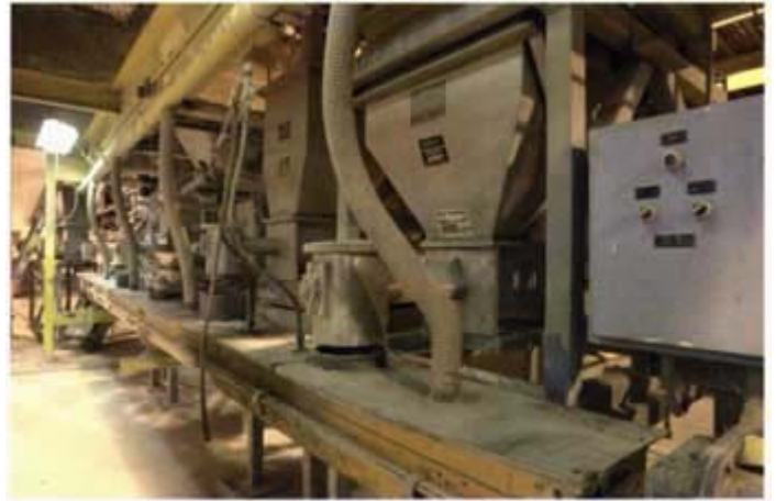
Para mejorar el control de calidad y proceso, Isolatek cambió de dosificadores volumétricos a dosificadores pérdida-de-peso en su planta de Huntington, Indiana.
